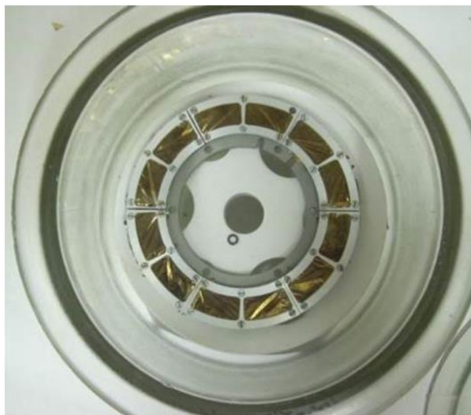
Фото мишени из 242\text{Pu} нанесенного на титановую фольгу толщиной 2 мкм
